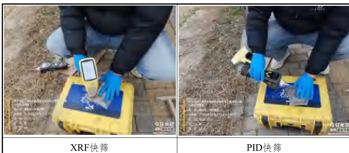
图 5.1-5 土壤样品现场快速测试图
