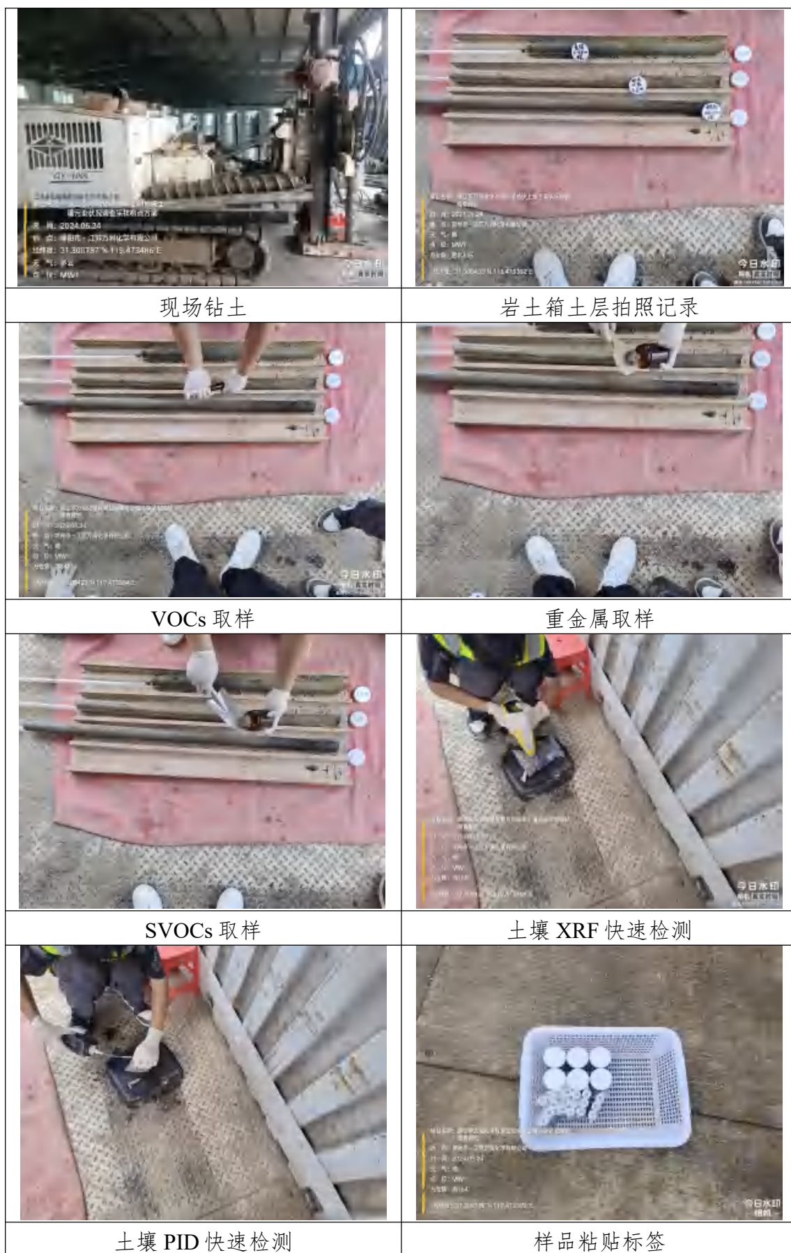
图 6.1-1 现场采集土壤样品图
