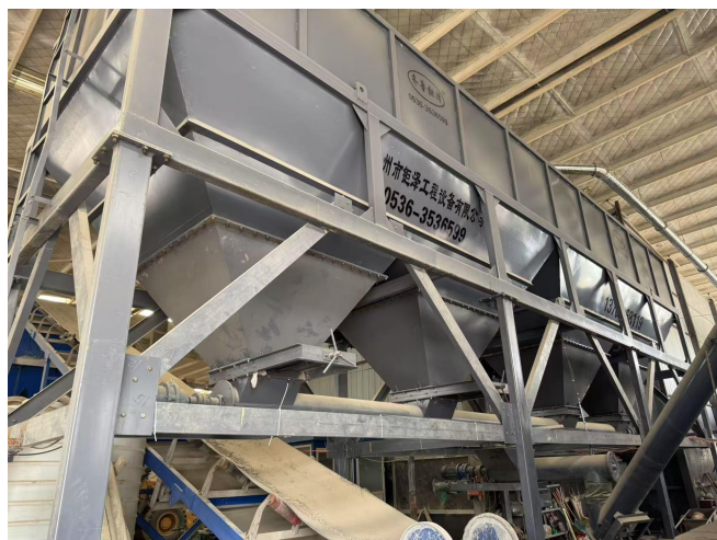
储仓内水泥+管道密闭传输至搅拌机
