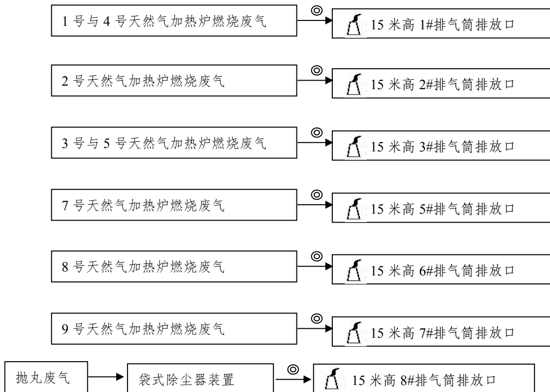
图 3-2 废气处置工艺及监测图示
